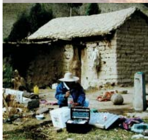
SODIS ёрдамида тозаланган ва хом сувнинг сифатини кўчма DelAgua таҳлил уекунаси кўмагида текшириши.
