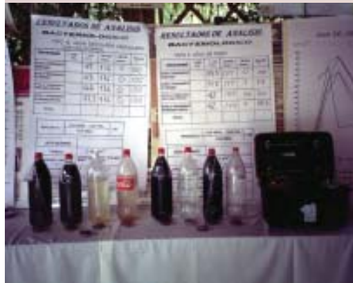
SODISнинг самарадорлигини намоён этиш учун тренинг вақтида, DelAgua ускунаси ёрдамида, дала шароитларида сувнинг сифатини текшириш.
